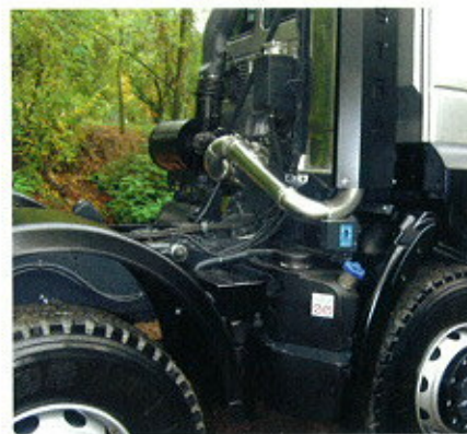
Lo scarico alto (che sovrasta il serbatoio dell'AdBlue) è molto apprezzabile nell'ambito di lavori stradali e con personale a terra.
